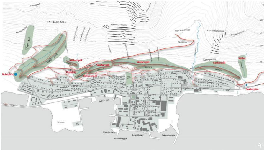
Mynd 18. Snjóflóðavarnargarðar ofan Siglufjarðar.
